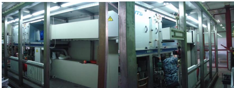
Фото 16, 17. Етапи виготовлення промислової установки потужністю 5 500 м 3 /годину.
