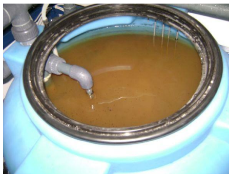
Фото 8. Стоки після промивання фільтруючого завантаження перед зливом у каналізацію.
