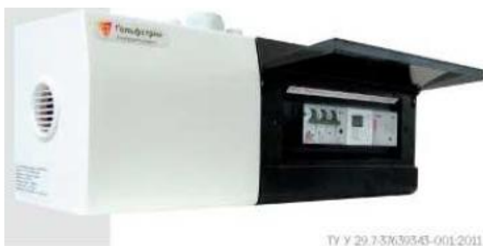
Фото 26. Трифазна мінікотельня потужністю 6÷35 кВт (габарити 505×160×180, маса — 6 кг).
